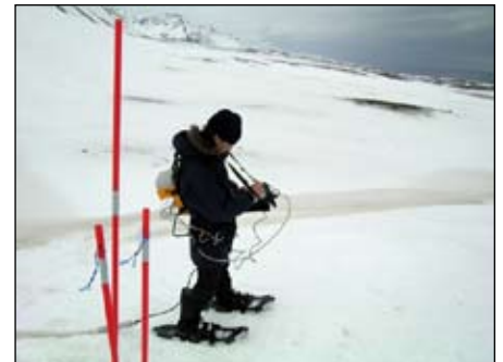
Mesure au GPR (ground penetrating radar) par le géophysicien allemand
