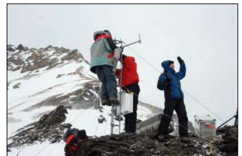
Installation de la station météo d'altitude avec l'aide des logisticiens de l'IPEV
