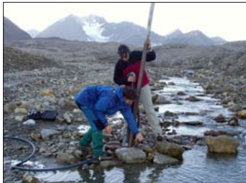
Pose d'une sonde hydrologique multiparamètre
